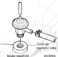
Fig. AC-30 Fast Idle Actuator
