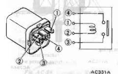
Fig. AC-35 Cooler Relay
